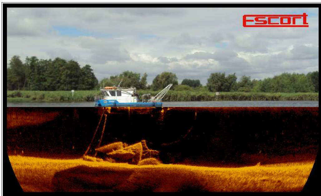
wrak - połączenie obrazu nawodnego i podwodnego
