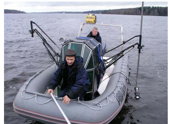
Głowica sonaru zamontowana na wysięgniku przegubowym
